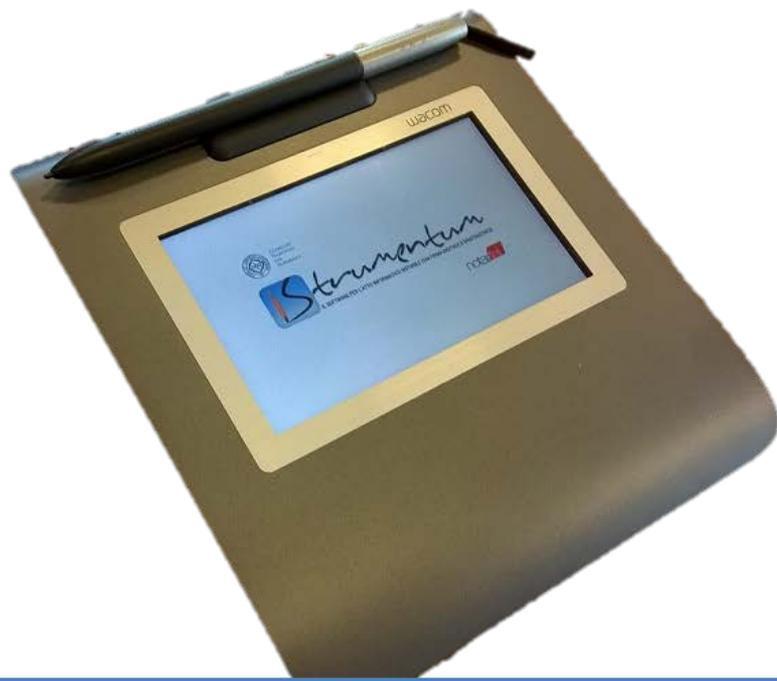
La **FIRMA GRAFOMETRICA** è una particolare «firma elettronica», ottenuta firmando su uno specifico supporto tecnologico quale tablet o pad di firma utilizzando una penna. È una firma biometrica capace di acquisire, grazie a campionature dedicate, una serie di dati comportamentali della persona che firma.
